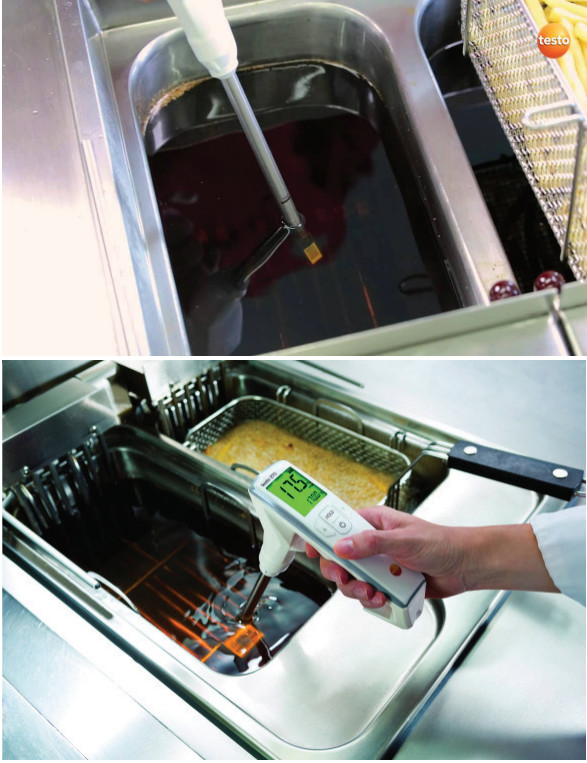
तार्ने तेलमा टोटल पोलार कम्पाउण्ड (Total polar compound) नाप्ने डिजिटल टेस्टोमिटर
